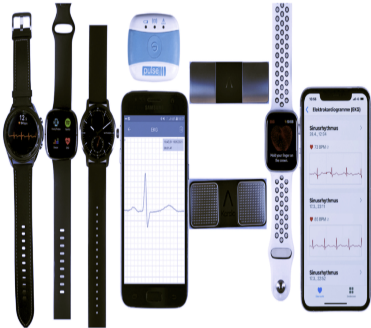
Fig. 3: dispositivi indossabili in grado di registrare l'ECG.
